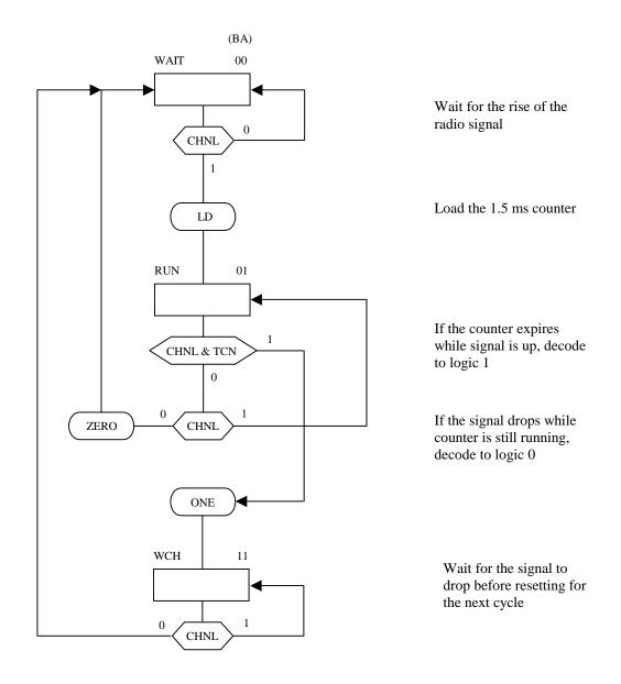
Picture 46: Radio decoder ASM (module CHANNEL)
